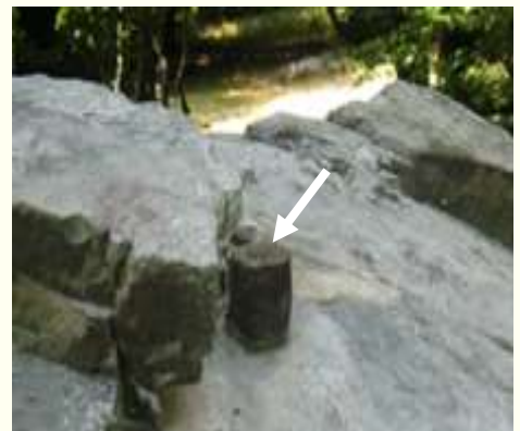
Der neu vermarktete eiserne TP-Bolzen auf dem Quarzitblock
